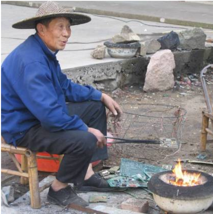
„entlöten“ von Bauteilen
