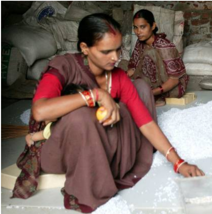
farbsortieren von Plastikchips
