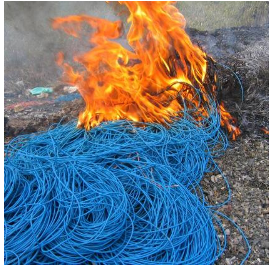
abbrennen von Isolationen
